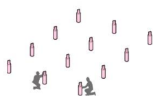
01. Posicionamento e instalação das fundações;
